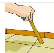
6.3. Pedra: mármore e granitos polidos: Antes da aplicação do piso, verifique se há peças soltas, ocas, danificadas. Se apresentarem qualquer tipo de problema, devem ser removidas e o preenchimento deve ser feito com uma argamassa de regularização adequada, descritas acima.
