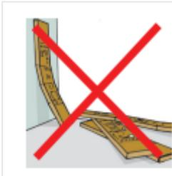
3.3. Caixas de piso e complementos devem ser armazenados em áreas limpas e planas e sobre bases elevadas em relação ao solo. Respeite o empilhamento máximo das caixas (informação impressa na embalagem).
