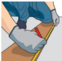
25.3. A primeira régua da segunda fileira deve ser alinhada no meio da régua da fileira anterior, a 2/3 ou de forma desencontrada – lembre-se de confirmar o tipo da instalação com o responsável pela obra. Depois, meça a largura da placa, desconte 5 centímetros e trace uma linha paralela à parede.
