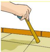
6.3. Pedra: mármore e granitos polidos: Antes da aplicação do piso, verifique se há peças soltas, ocas, danificadas ou deslocadas. Se apresentarem qualquer tipo de problema, devem ser removidas e o preenchimento deve ser feito com uma argamassa de regularização adequada, descritas acima.
