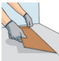
Para marcar o eixo, tome como base a parede de início da instalação, conforme paginação. Meça a largura da régua e trace uma linha paralela à parede, no mínimo 1cm menor que essa largura.
