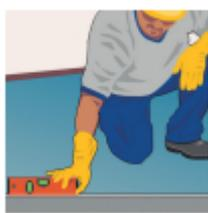
5.2. Contrapiso plano. A planicidade do contrapiso deve ser medida com uma régua de 2m. Para instalação de pisos vinílicos, devem-se cumprir as normas ABNT NBR 14.917-2:2022 e ABNT NBR 15.575-3:2013, que estabelecem um máximo de 3mm de desnível entre dois pontos quando se utiliza a régua de 2m. Eventuais irregularidades, depressões, ondulações, rugosidades ou qualquer outro ponto que possa afetar no aspecto estético do piso vinílico instalado deverão ser corrigidos adequadamente.
