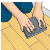
25.7. Ao finalizar, pressione as régua com uma régua de madeira revestida com carpete ou rolo compressor de 50kg para que fiquem bem aderidas ao contrapiso.
